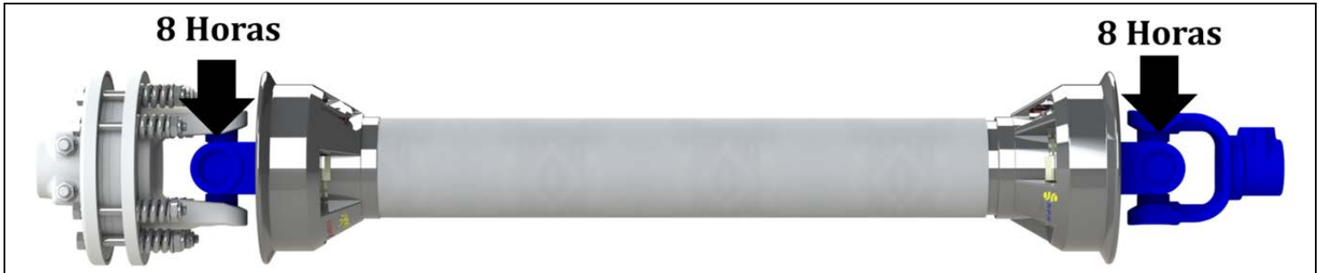
Figura 7. Intervalos de Lubricación de las Juntas Universales
