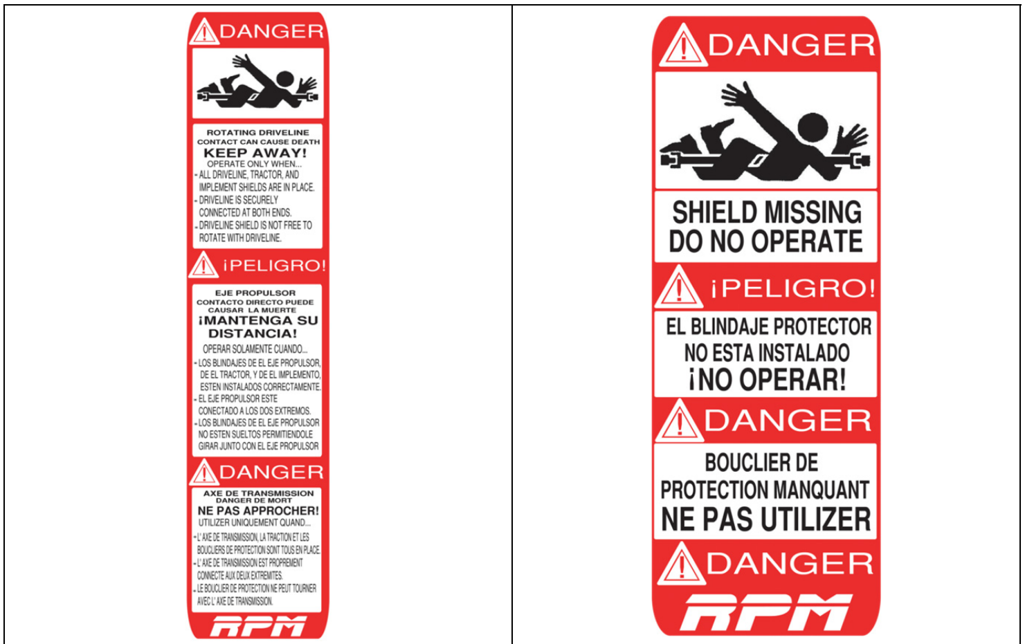
Figure 1. Étiquette D'avertissement du Bouclier de Protection de L'axe de Transmission
